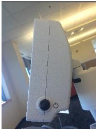
**Abbildung 3-1. Netzschalter**
