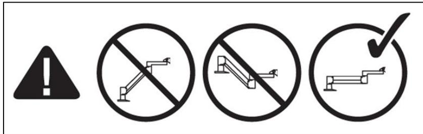
*Figura 4-4. Coloque el brazo paralelo al suelo*
