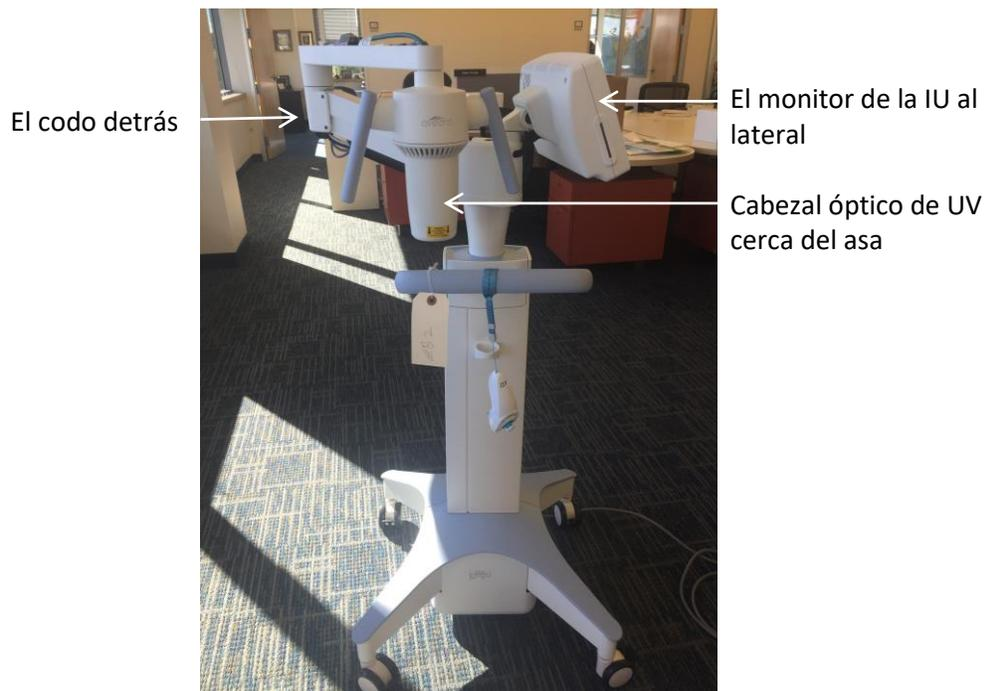
**Figura 4-8. Configuración para el desplazamiento del sistema**
