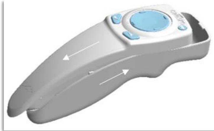
**Figura 4-1. Acceso al compartimento de pilas**
