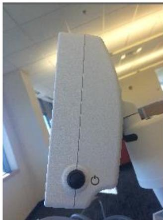
**Figura 3-1. Conmutador de encendido**
