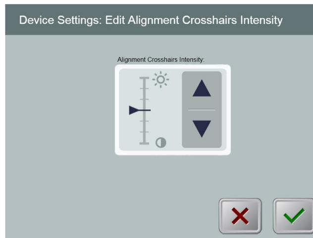
Figura 3-35. Modifica dell'intensità dei crocini di allineamento
