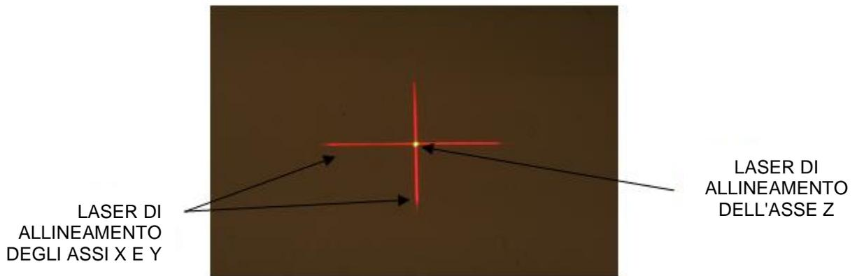
**Figura 3-21. Allineamento dei crocini rossi degli assi X e Y e del puntino verde dell'asse Z**
