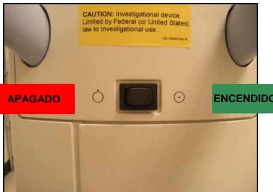
Figura 3-1. Interruptor de encendido
