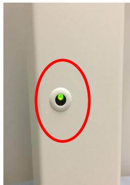
*Figura 3-31. Indicador de estado de la batería del sistema KXL*
