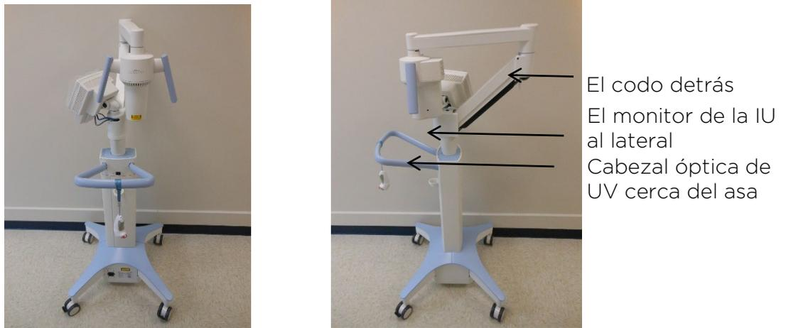
*Figura 4-7. Configuración del desplazamiento del sistema*
