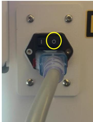
Figure 3-49. Position de mise hors tension
