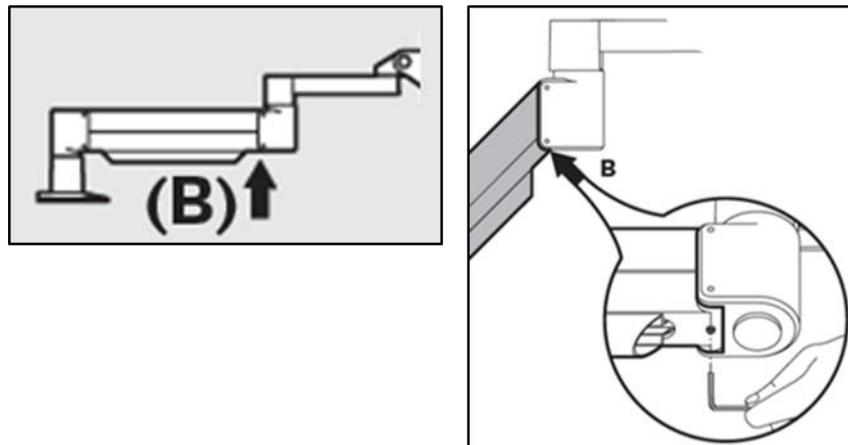
Figure 4-6. Desserrer la vis de réglage de contrepoids B
