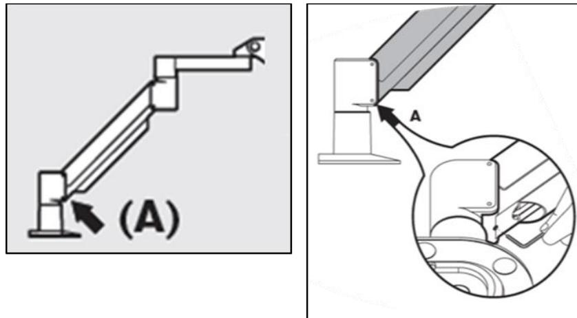
Figure 4-5. Desserrer la vis de réglage de contrepoids A
