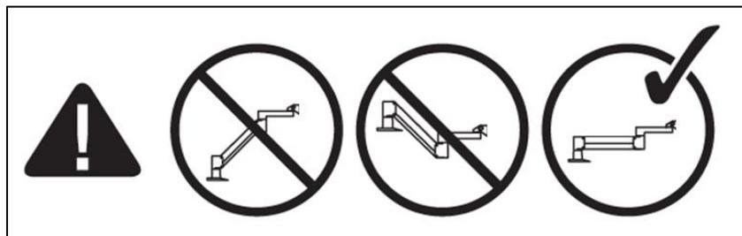
Figure 4-4. Positionner le bras parallèlement au sol
