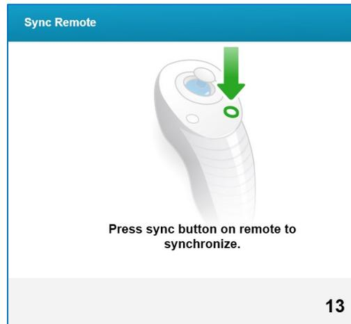
Abbildung 46. Bildschirm der Synchronisation der alten Fernbedienung
