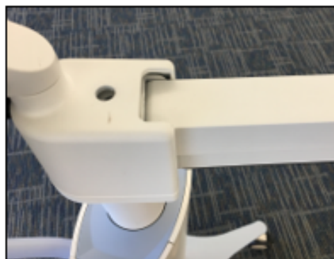
شکل 43. تنظیم کشش بازو با پیچ تنظیم سختی C
