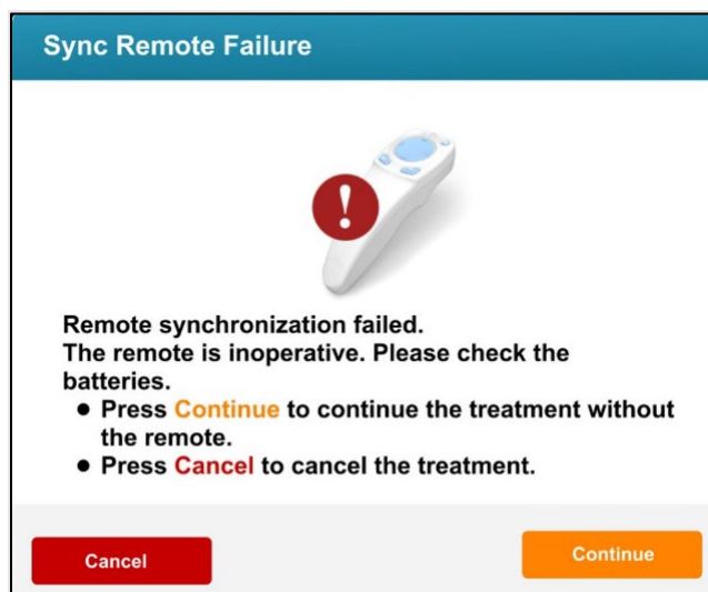
شکل 14. نقص همگامسازی کنترل از راه دور
