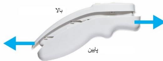
شکل 37. دسترسی به جای باتری
