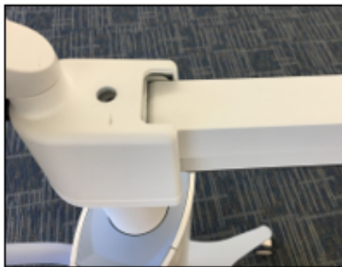
43. ábra. A kar feszességének beállítása a „C” erősségbeállító csavarral
