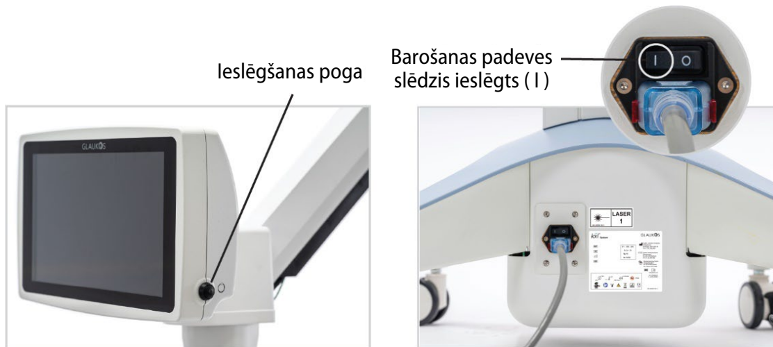
7. attēls. ieslēgšanas poga (pa kreisi) un barošanas padeves slēdzis (pa labi)
