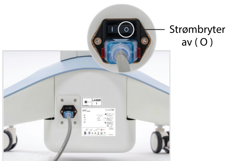
Figur 34. Nettstrømbryter i av-posisjon
