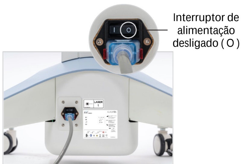
Figura 34. Interruptor de alimentação na posição desligado
