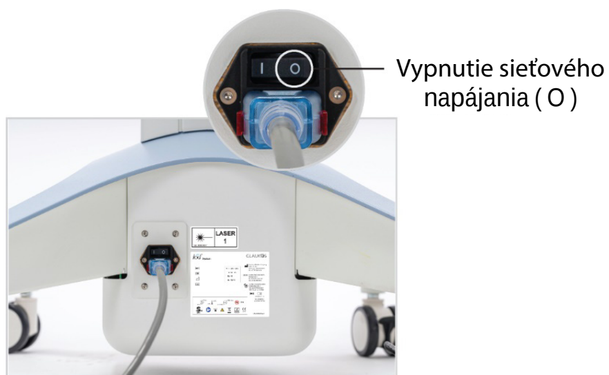
Obrázok 34. Hlavný vypínač je v polohe Vypnuté
