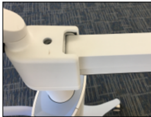
รูปที่ 43 ตั้งค่าความตึงแขนยึดด้วยสกรูปรับระดับความแข็งแรง C
