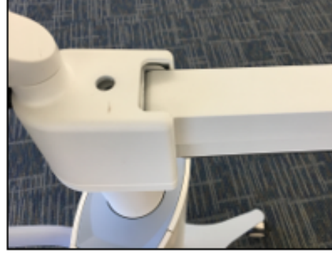
Şekil 43. Güç Ayarlama Vidası C ile Kol Gerginliğini ayarlayın
