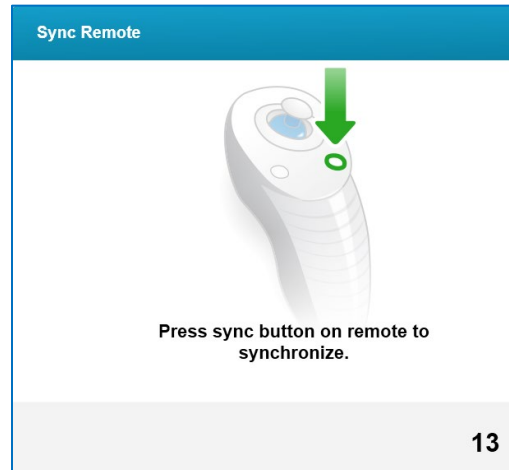
Hình 46. Bộ điều khiển từ xa thế hệ cũ – Màn hình đồng bộ hóa bộ điều khiển từ xa
