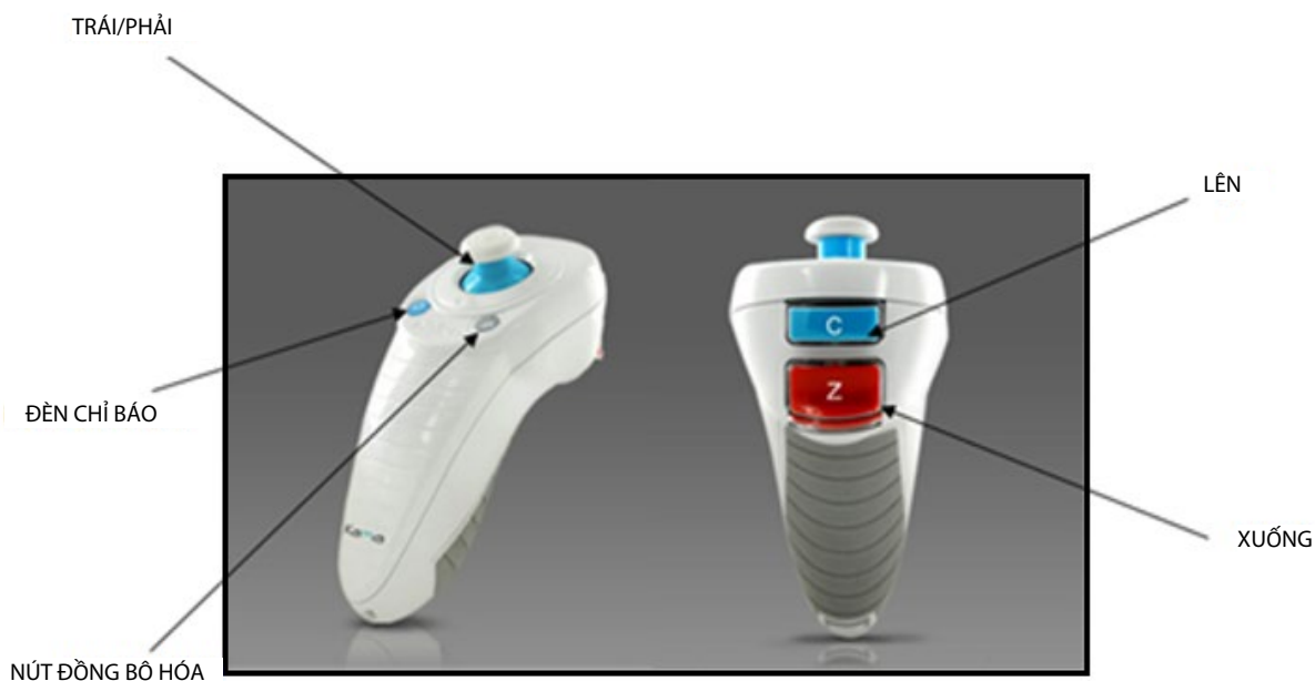
Hình 45. Tổng quan về bộ điều khiển từ xa thế hệ cũ
