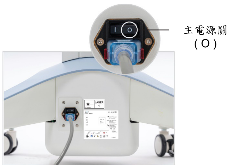
圖 34：主電源開關處於關閉位置
